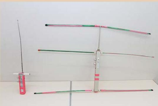
▲ARDFでは3.5MHz帯と144MHz帯の2種類の周波数で競技大会が開催されます。3.5MHz用の無線受信機 (左) と144MHz用の無線受信機 (右)
