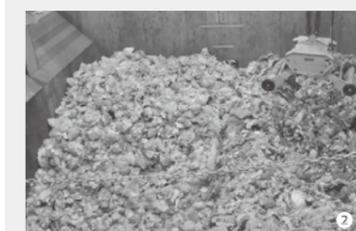
2 約518トンの可燃ごみを貯めておくことができる「ごみピット」。常時負圧で密閉され、臭気漏えいを防いでいます。「ごみクレーン」で攪拌(かくはん)した後、焼却炉へのごみが送られます。
