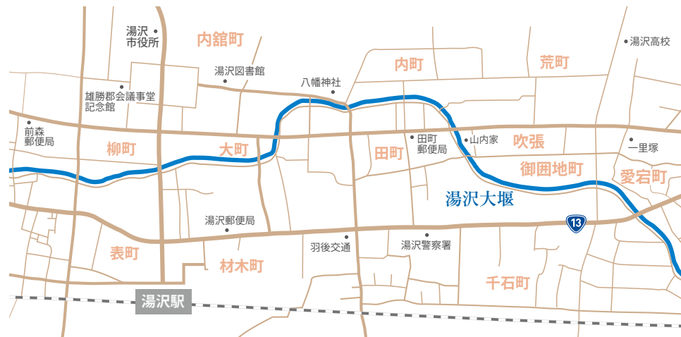
雄物川から取水し、市の中心部を北上する「湯沢大堰」
