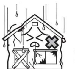
⑥腐朽による倒壊の防止 (雨水の浸入を防ぐ、シロアリの駆除など)
