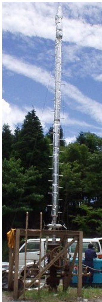
圧力モニタリング装置を入れた井戸の例 (万が一蒸気が吹いた場合でもこれを止める安全装置を付けた例)
