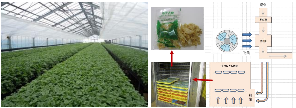
図8 水耕栽培の様子と温泉水の熱風活用のイメージ
